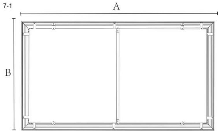
取適當距離於牆壁鑽孔。水平的兩孔寬度為寬度總長( A )的2/3長。垂直的兩孔高度為高度總長( B )減105mm。
