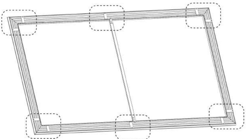
使用圓頭螺絲將2個掛架鎖在上框架。不要完全鎖緊，讓掛架可以左右滑動。
