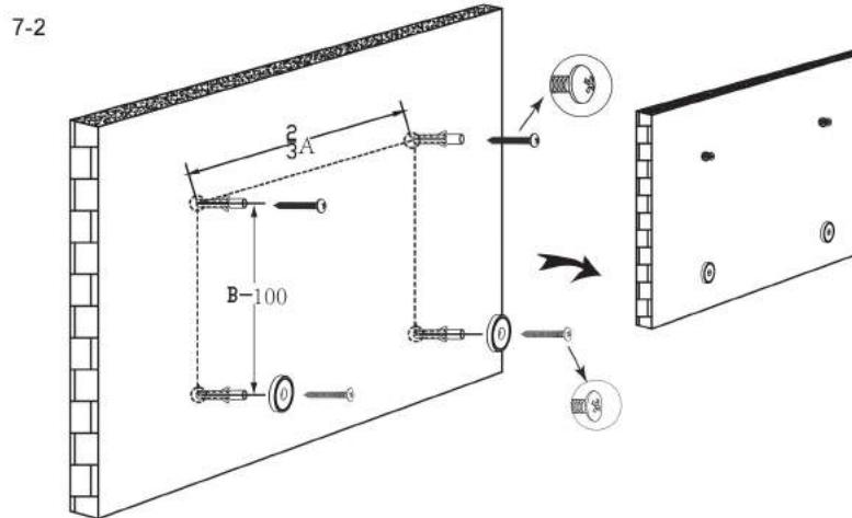
將膨脹螺栓鑽入4個鑽孔並突出5mm長度來吊掛布幕。上方2個孔洞鎖上圓頭螺絲，下方2個孔洞加上圓形磁鐵片鎖上平頭螺絲。
