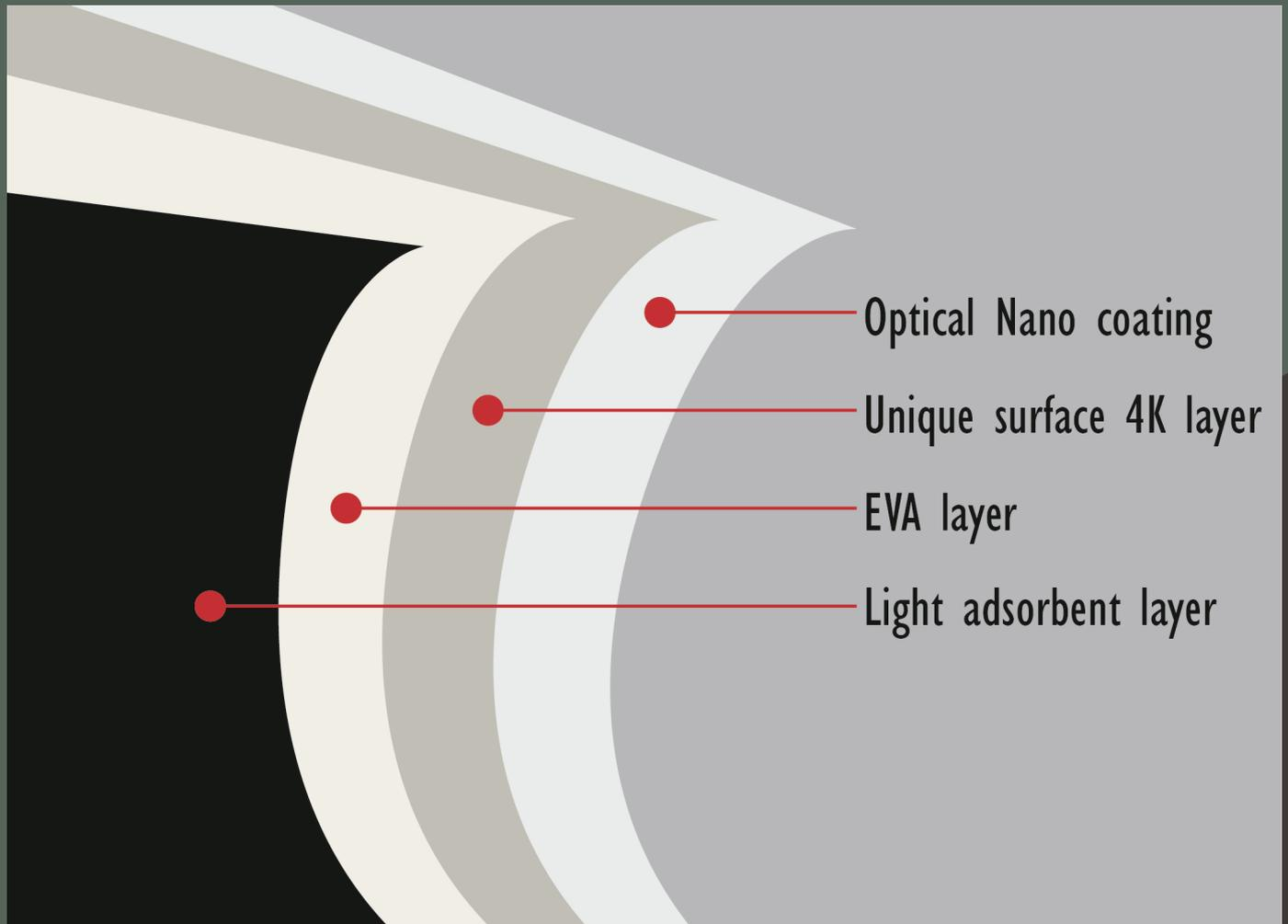
具有一定強度而且收縮率較低，可以對抗極大的溫差變化（-20度~60度），在較為極端的環境中仍維持平整。
