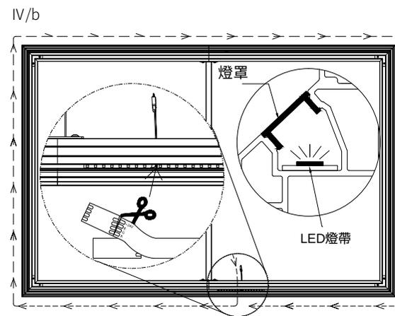
IV/c. 取延長線一頭連接燈帶端，另一頭連接電源控制盒，插上電源即可亮燈。詳細控制功能見二維碼。
