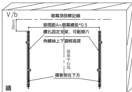
V/c. 兩人水平抬起組裝好的銀幕，稍微傾斜掛入後方凹槽內。掛牢固後輕放銀幕，投影畫面，左右輕輕推動銀幕至左右居中，頂起安裝桿下方的彈性倒扣，使其扣緊銀幕，完成銀幕安裝。
