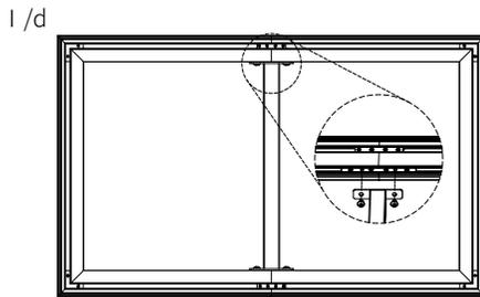
I/d. 取F7架在框架內部（尺寸大於150吋時配三條），對齊已預裝好的S3，用M6\*8螺絲鎖緊；完成幕布框架的连接。
