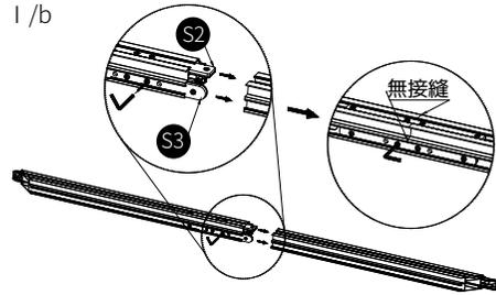
I/b. 取出F1、F2，其中一條框有預裝連接件S2、S3；只須用六角板手鬆開頂螺絲，拔出並插入另一邊的框架；移至左右居中，調整至無縫隙，鎖緊全部頂螺絲，即可完成兩對橫框架的连接。
