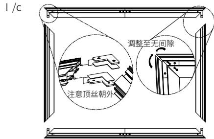
I/c. 取一對F3和上一步連接好的橫框，分別對邊擺成一矩型；用兩S1分別插入型材的大槽口內（注意頂螺絲朝外）。調整位置至齊平，鎖緊兩側頂螺絲，完成四邊的連接。
