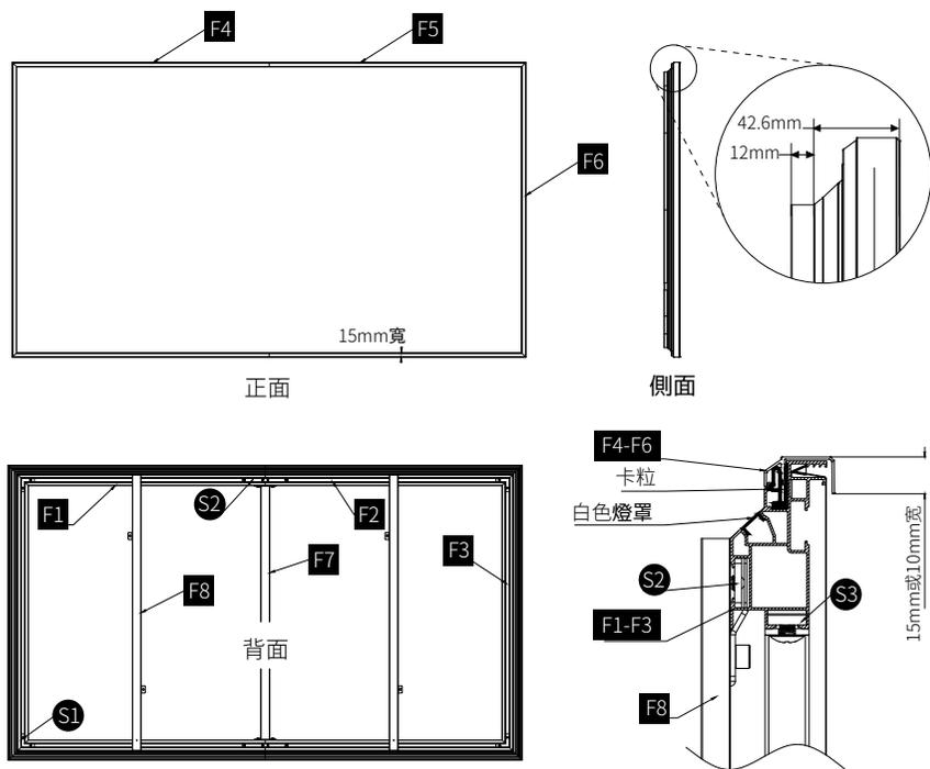
IV/b. 在橫框架上尋長條型的過線孔，取LED燈帶其中焊端子的一端，穿過型材過線孔。一邊撕開雙面膠，一邊延孔線框一圈貼在燈罩槽內壁，多出的部份需按燈帶標誌線裁剪。
