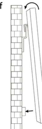
f.將螢幕掛回，左右移動至磁鐵位置，輕輕放置螢幕，完成螢幕的壁掛安裝。
