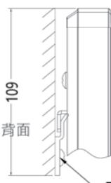
a.翻轉螢幕以確保方向正確。將S6安裝在上框槽內（注意掛鉤應朝後）。安裝間距A=0.52\*L。
